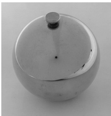
Slika 2.3: Leta 1905 izdelana pozlačena medeninasta krogla z maso 1 kg in volumnom 1 dm 3 (1 liter). Predstavljala je prvi artefakt enote za maso, ki je temeljil na takratni definiciji kilograma kot mase enega litra vode.
