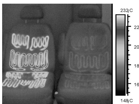
Slika 6.55: Uporaba sevalnega termometra (termovizijske kamere) pri ugotavljanju kvalitete izdelave gretja avtomobilskih sedežev [3].
