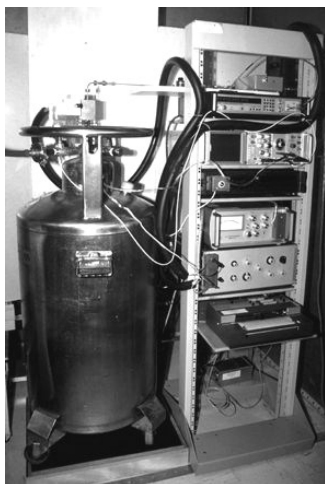
Slika 6.39: Sistem naprav in instrumentov za izvedbo etalona napetosti z Josephsonovim spojem [6].
