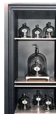
Slika 6.17: Prakilogram K in šest delovnih rezervnih etalonov (Témoins), ki se vsakih 12 let primerjajo s K.
